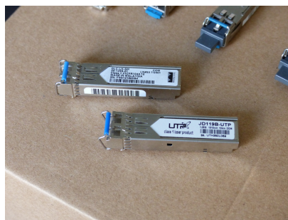
Figure 7: Transceivers propriétaires versus transceivers génériques
