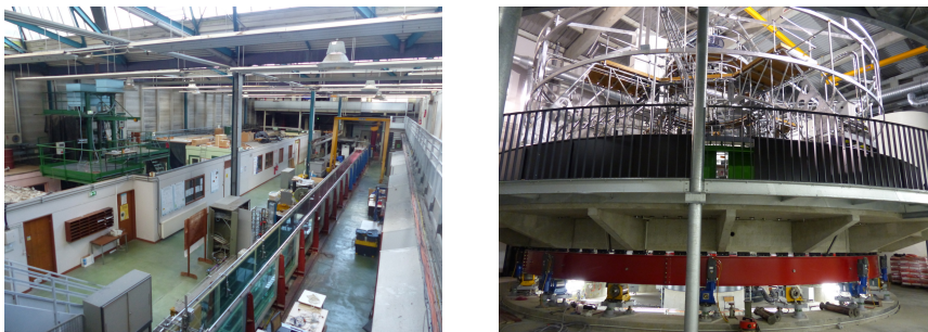
Figure 2: Canal à houle de 36m de long et plaque tournante CORIOLIS II
