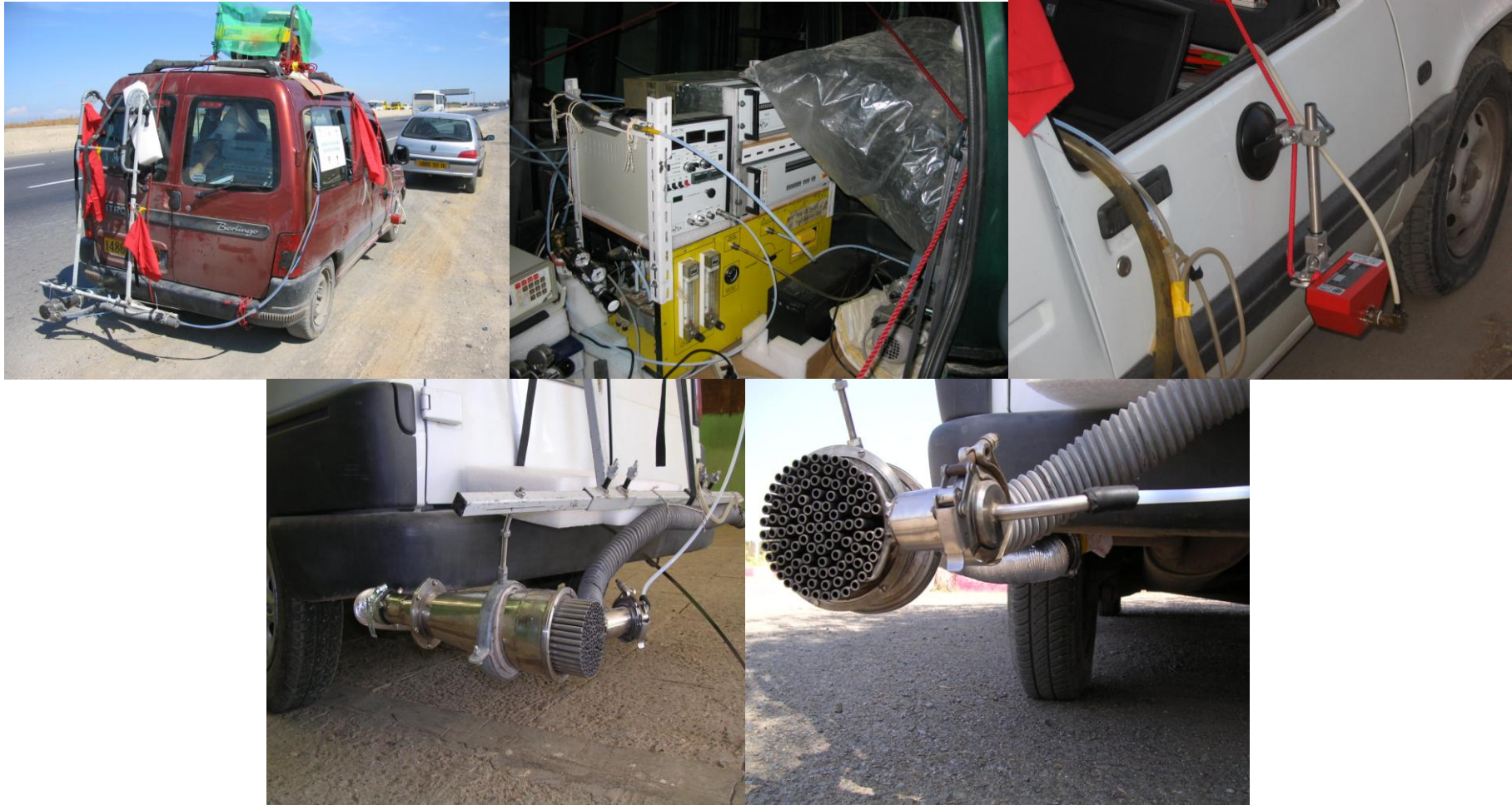
Figure 2: Photos du montage expérimental de mesure embarqué en circulation réelle
