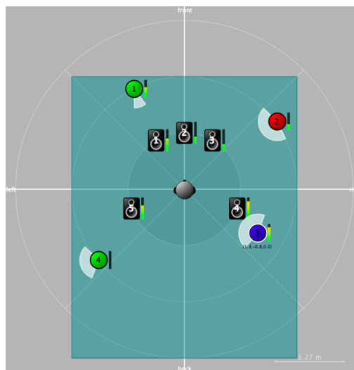
Figure 6. Interface du spat.viewer avec quatre sources sonores, cinq haut-parleurs et un auditeur, situés dans un environnement virtuel. Représentation en vue de dessus.
