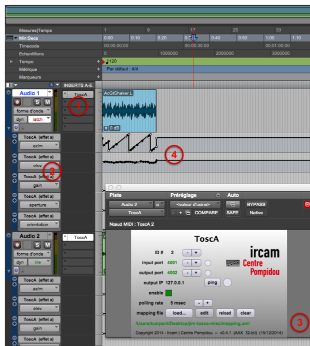
Figure 6. Vue du plugin Tosca dans ProTools. ① plugin en insert sur la piste 1. ② liste des paramètres exposés. ③ fenêtre du plugin . ④ pistes d'automation.
