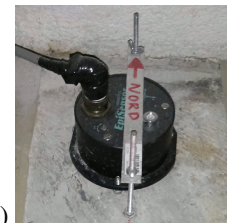
Figure 3: Accéléromètres mono (a) et 3-composantes (b).
