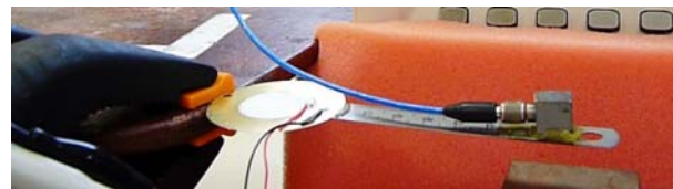
fig.2 Poutre piézoélectrique et accéléromètre.
