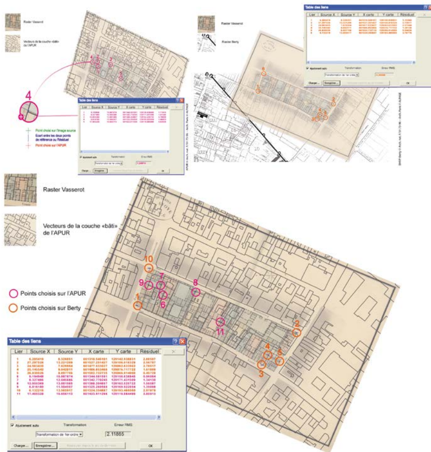
Figure 3. Procédure de géoréférencement
