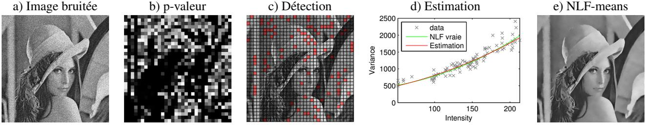
FIGURE 1 – Processus d’estimation du bruit dans une image corrompue par un mélange de bruits gaussien, poissonnien et multiplicatif, correspondant à des paramètres  $(a, b, c) = (0.0312, 0.75, 400)$  et à un PSNR initial de 17.93dB. a) Image bruitée, b) p-valeur associée au  $\tau$  de Kendall calculé sur des blocs de taille  $W = 16$ , c) Sélection des zones homogènes, d) Estimation de la NLF, e) Débruitage NLF-means, PSNR = 30.22dB.
