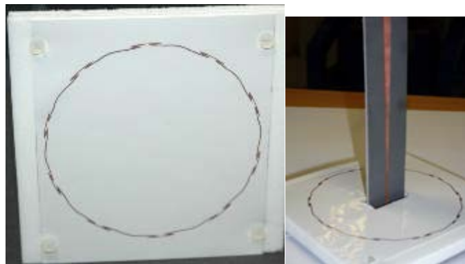
Figure 1: Anneau pré-fractal (gauche) et anneau pré-fractal placé sous une antenne spirale et entourant le balun (droite).
