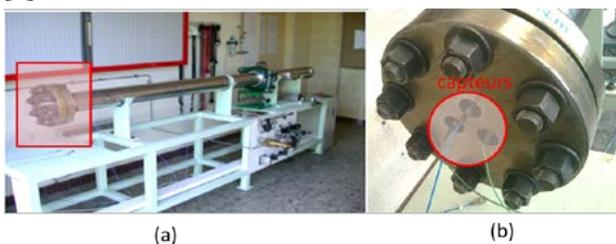
Figure 4. (a) Tube à choc du CEA Gramat et (b) montage du capteur en fond de tube.
