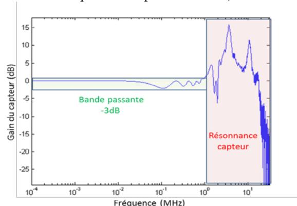
Figure 7. Réponse en fréquence du capteur PVDF.
