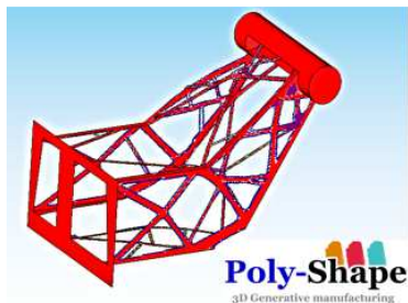
Figure 7. RESULTAT D'OPTIMISATION AVEC DES SURFACES.
