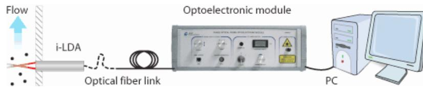
Figure 3 Chaîne de mesure associée au  $\mu$ -LDV.
