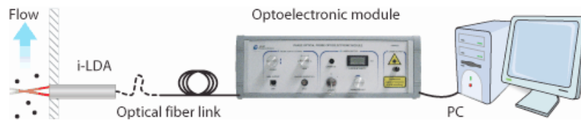
Figure 3 Chaîne de mesure associée au \mu -LDV.
