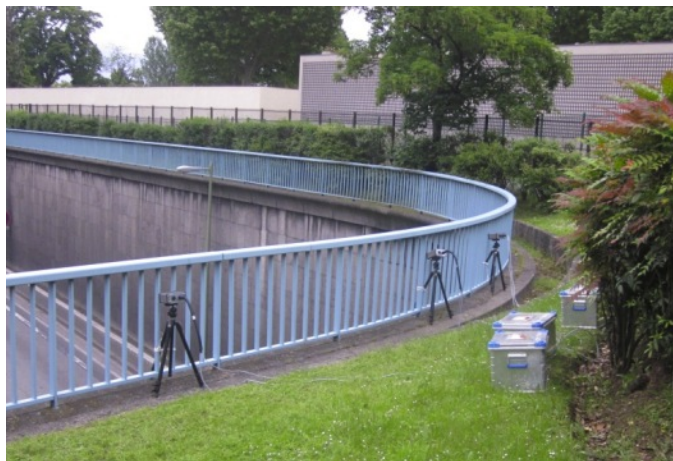
Figure 5. Caractérisation des parcs automobiles par observation vidéo : Trois caméras en surplomb du boulevard périphérique parisien
