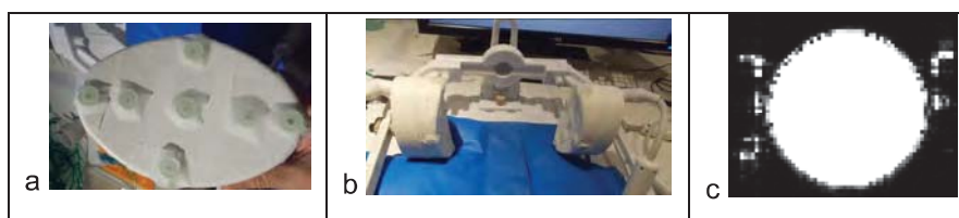
Figure 1. Coque équipée de marqueurs (a) de l'antenne Noras 8 canaux (b), et image sur fantôme (c)
