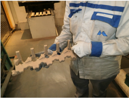
FIGURE 8: Un noyau après ébavurage (Montupet)
