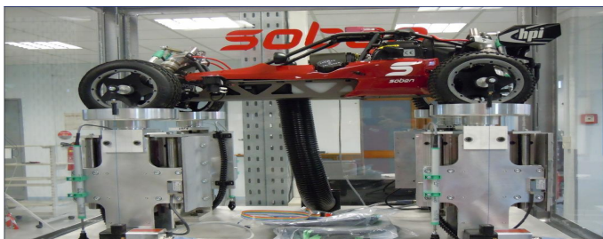
Fig. 14. Le mini-véhicule équipé 4 amortisseurs ER semi-actifs.
