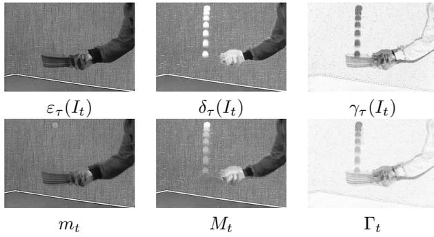
Figure 7: Application des opérateurs morphologique oublioux (en bas), comparés aux opérateurs morphologiques classiques (en haut), calculés à la trame  $t = 19$  de la séquence ‘Tennis’ (Berkeley). Pour comparaison, les opérateurs morphologiques classiques utilisent pour élément structurant le segment dans la dimension temporelle  $\tau = [-8, 0]$ ; et les opérateurs morphologiques oublioux  $\alpha = 1/9$ . Les gradients sont affichés en mode vidéo inversé.
