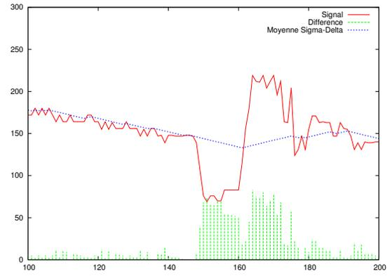
Figure 9: Filtrage  $\Sigma$ - $\Delta$ . La courbe rouge correspond à la séquence originale, la courbe pointillée bleue à la moyenne  $\Sigma$ - $\Delta$  et la courbe en tiret vert à la différence à la moyenne.
