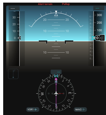
Figure 5. Le Primary Flight Display (PFD) développé
