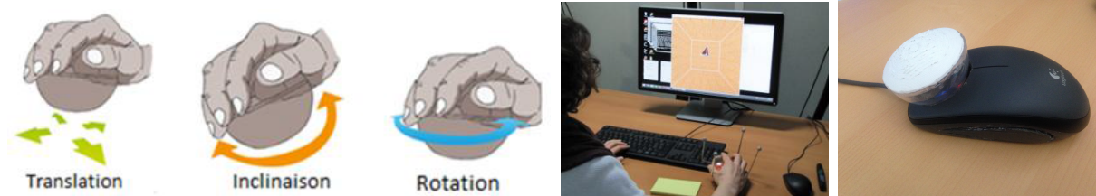
Figure 1. A gauche, les trois manipulations de Disco, dispositif basé sur le principe du culbuto. Au centre, utilisation de Disco pour déplacer et orienter un objet en 3D. A droite, Souris-Disco, un dispositif composite associant une souris classique augmentée d'une version réduite de Disco tout en conservant les trois types de manipulations énoncés précédemment.
