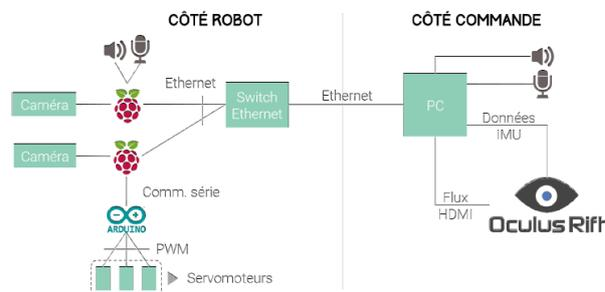
Figure 1. Architecture matérielle du projet With U
