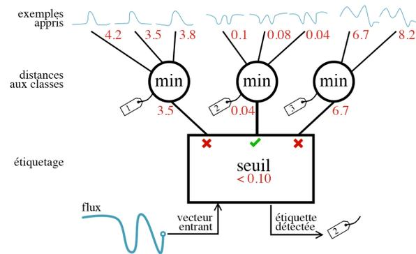
**Figure 2** – Architecture de l'étage de détection sur un exemple de flux ;  $d = 1$  par simplicité. Un vecteur entrant est obtenu et permet de mettre à jour la distance à chaque exemple, puis la distance aux classes. Une étiquette est délenchée si l'une des classes passe sous un seuil fixé.
