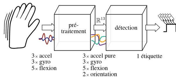
**Figure 1** – L'étage de pré-traitement et l'étage de détection fonctionnent en *pipeline* pour la reconnaissance en temps réel.
