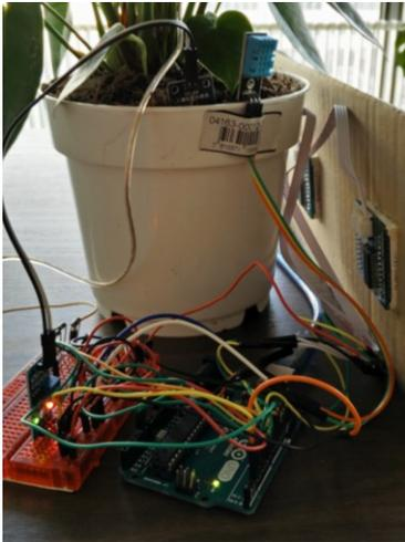
**Figure 3.** Le système EmotiPlant : détail de l'implémentation.
