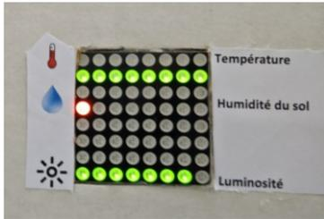
**Figure 4.** Détail de l'histogramme des paramètres environnementaux.
