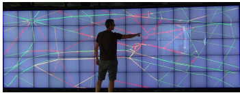
FIGURE 2 – Notre mur d'écrans interactif de 5,9m × 1,96m, pour une résolution de 14 400 × 4 800 pixels. Ce mur est contrôlé par un cluster de 10 ordinateurs et possède un cadre PQ labs qui permet de détecter le toucher sur le mur. Nous utilisons Java avec la bibliothèque zvtm-cluster [16] pour la programmation.
