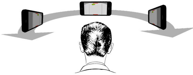
Figure 5. Modalité interaction physique : pour un accès direct à des données, l'utilisateur déplace le dispositif sur un ruban virtuel placé en arc de cercle devant lui et correspondant à l'espace des données.
