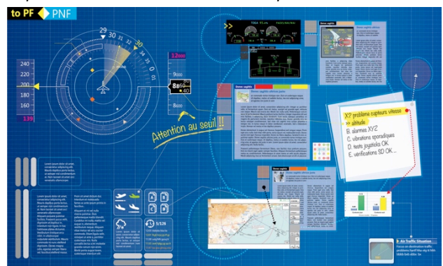
Figure 9 : Composition libre des informations sur la zone PNF (Pilot Non Flying) du cockpit d'une surface interactive permettant l'exploration d'une solution à un problème de vol.
