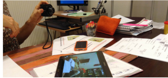
Figure 9. Dispositif d'assistance en classe, « bricolé » par l'ergothérapeute. Il s'agit d'une caméra connectée en bluetooth à une tablette, qui peut être utilisée pour agrandir l'image au tableau.
