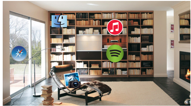
Figure 2. LociPad repose sur la même interaction que SpotPad, mais au lieu de s'appuyer sur une grille, cette technique utilise une image familière pour associer des commandes à des objets (loci) de l'image. Par exemple iTunes et Spotify sont à proximité de la chaine hifi. Safari est sur la fenêtre pour donner accès à l'extérieur
