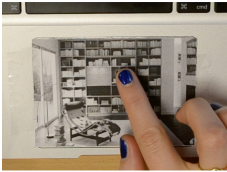
Figure 5. LociPad repose sur la même interaction que SpotPad, mais au lieu de s'appuyer sur une grille, cette technique utilise une image familière pour associer des commandes à des objets (loci) de l'image. Par exemple iTunes et Spotify sont à proximité de la chaîne hifi. Safari est sur la fenêtre pour donner accès à l'extérieur
