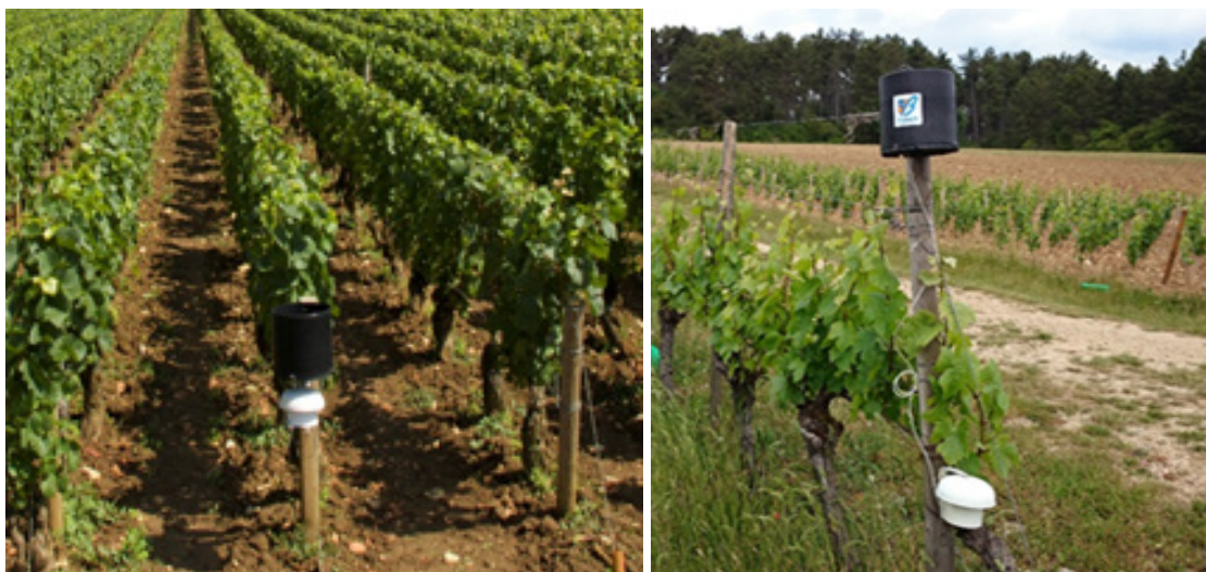
Photos 2 : Exemples d'implantation d'un pluviomètre. Gauche : en vignes basses (entre 85 cm et 1 m). Droite : en vignes hautes (entre 1,80 et 2 m). Left: low vines rain gauge implementation (between 85 cm and 1 m). Right: high vines rain gauge implementation (between 1.80 and 2 m). Clichés : B. Pauthier, 2014.
