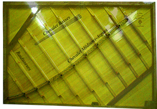
Figure 1 : Vue arrière de la table d'harmonie et de ces raidisseurs. Les chevalets sont vus par transparence.
