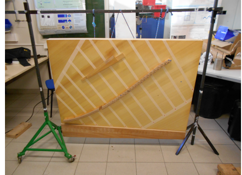
Figure 3 : Suspension de la table, collée à son meuble
