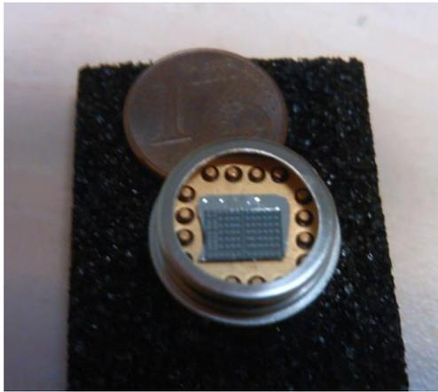
Figure 5. Photo des capteurs mis en boîtier
