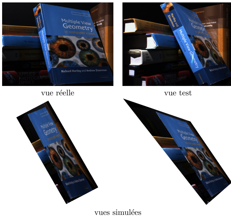
FIGURE 4 – Un exemple de simulation. Les vues simulées de la couverture du livre (affine à gauche et homographique à droite) sont obtenues à partir de la vue réelle. La simulation par homographie ressemble d’avantage à la vue test
