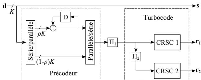
FIG. 1: Structure de l’encodeur d’un turbocode précodé.
