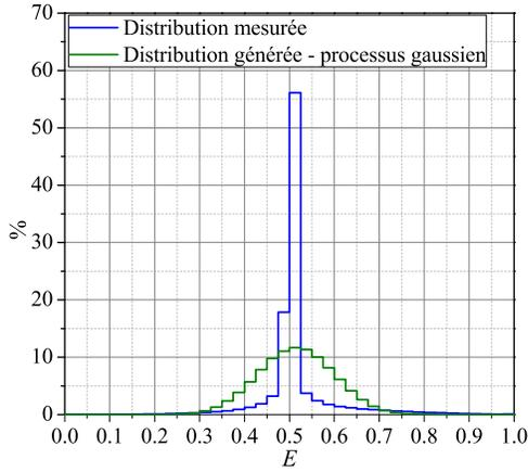
FIG. 2: Histogrammes de l'information extrinsèque  $E$  à l'entrée de SISO 1 générée dans SISO 0 et SISO 2 sans information *a priori*, pour  $\rho=0.11$ ,  $K=1504$  et  $R=4/5$ , évaluée à  $E_b/N_0 = 2$  dB sur canal gaussien.
