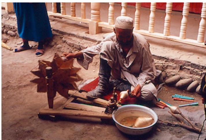
Fig. 13 – Tordage de la soie dans le même atelier de Khotan que fig. 4 (2002). Le tordage est réalisé avec une roue à bobiner qui tire du sommet du fuseau près de la main gauche de l'opérateur un fil double dont chaque élément a déjà reçu avec le même dispositif une torsion en sens inverse tout en étant doublé. Comparer avec fig. 12 (bas, gauche). © S. Desrosiers
