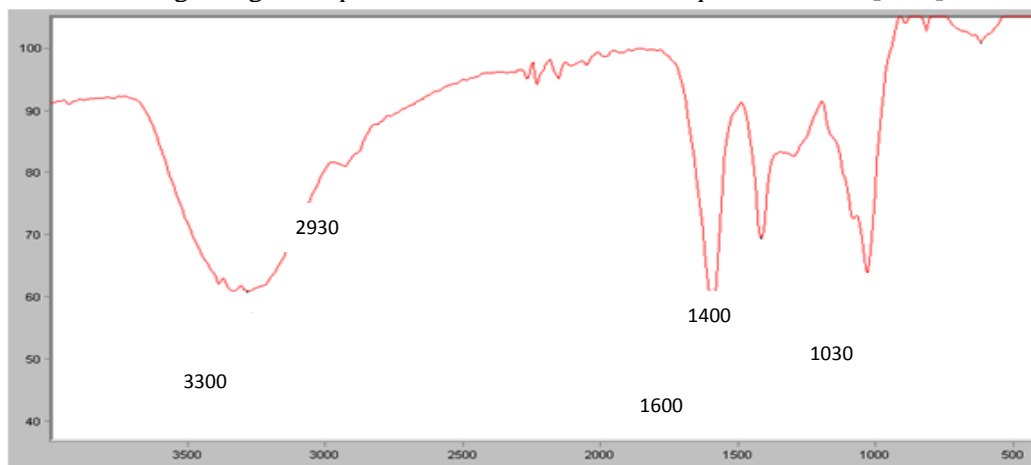
Figure 2 : Caractérisation des billes par FTIR
