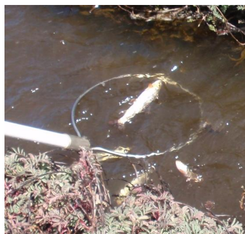
Figure 6: L'anode attire les poissons dans une zone qui dépend de la puissance électrique ainsi que de la conductivité.
