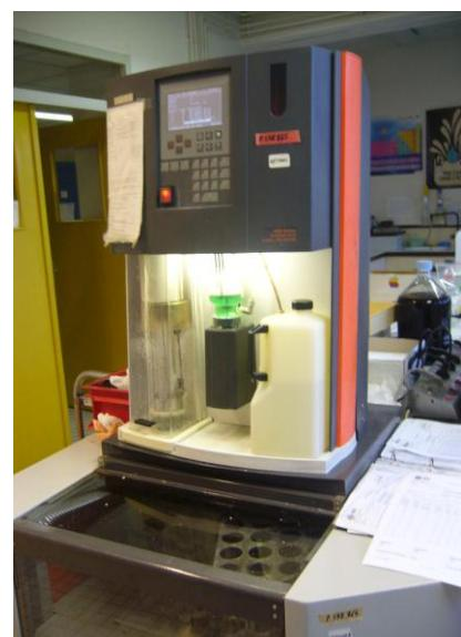
Dispositif de distillation et de dosage de l'azote
