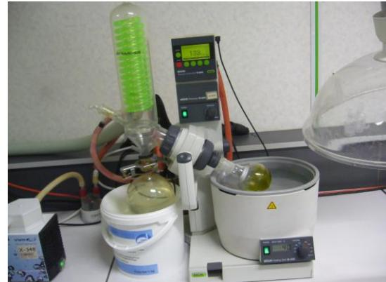
**Dispositif d'évaporation (rota vapor)**
