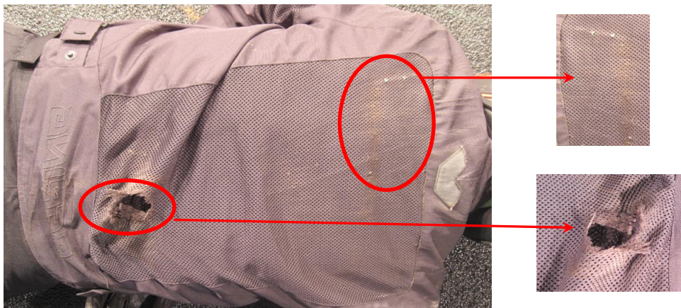
Figure 5 : Etat du blouson « Légers » après glissade à 30km/h sur sol avec coefficient de frottement de 0.8
