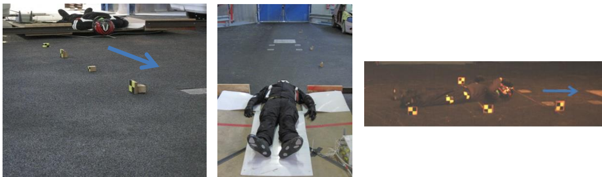
Figure 2 : Test de glissade à 30km/h
