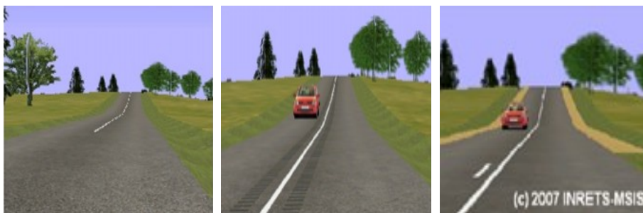
Figure 3. Caractéristiques visuelles du second sommet de côte ; de gauche à droite : référence sans aménagement, bandes d'alerte sonore, accotement revêtu.
