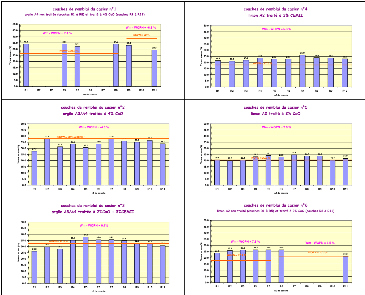
Figure 8 : teneurs en eau de chaque couche de remblai pour tous les casiers
