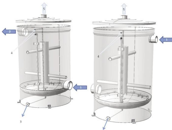
1) Alimentation en eau brute ( $140\text{m}^3\cdot\text{h}^{-1}$ ) ; 2) Evacuation de l'eau traitée ; 3) Vanne de vidange ; 4) Injection d'air ( $70\text{ m}^3\cdot\text{h}^{-1}$  par filtre) ; 5) Evacuation de l'air.
