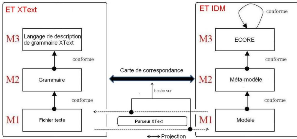
Figure 4. Utilisation de XText pour réaliser la projection
