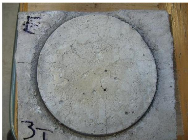
Fig. 3 : Face exposée à la flamme propane 1h.
