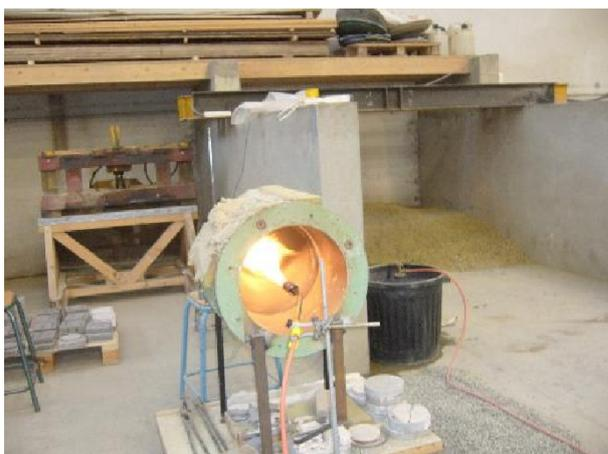
Fig. 2 : Appareillage pour chauffage à la flamme propane.
