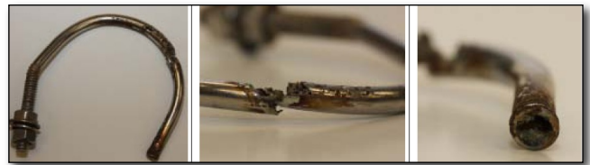
Fig. 9. Stainless steel bracket corrosion [28].
