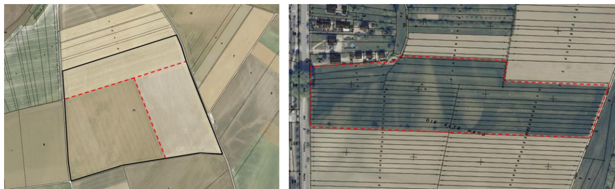
Gauche : plusieurs parcelles culturales (limites rouges) dans une parcelle cadastrale (limite noire). Droite : plusieurs parcelles cadastrales (limite noire) dans une parcelle culturale (limite rouge)
