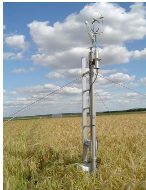
**Figure M31.1. Système de mesure de flux de CO<sub>2</sub> par covariance turbulente (source: INRA)**
