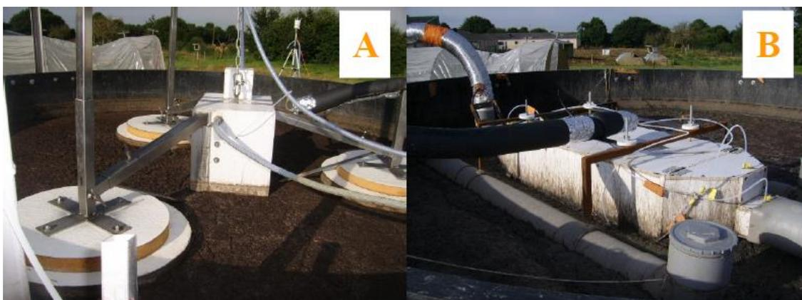
Figure C10.1. Dispositifs de chambres dynamiques testées pour la mesure d'émissions gazeuses au stockage de lisier porcin
