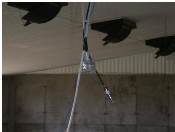
Figure C5.3. Tube d'échantillonnage, filtre, sonde d'humidité et température
