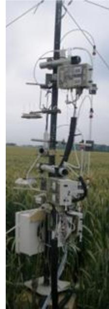
Figure M28.1. Gauche : Schéma illustrant la mesure d'un gradient de NO, NO<sub>2</sub> et O<sub>3</sub> à trois niveaux à l'aide d'une pompe principale, d'électrovannes de dérivation et d'analyseurs de gaz (Stella *et al.*, 2012). Droite : Photo montrant un dispositif de mesure du gradient d'NH<sub>3</sub> à l'aide d'un analyseur à flux continu multi-canaux équipé de denuders liquides (ROSAA) (Loubet *et al.*, 2012)
