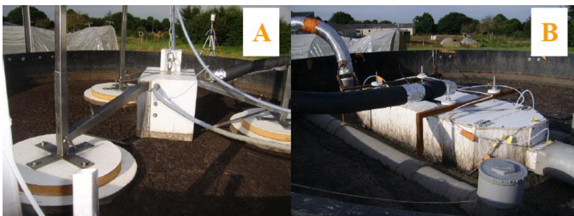
Figure C10.1. Dispositifs de chambres dynamiques testées pour la mesure d'émissions gazeuses au stockage de lisier porcin
